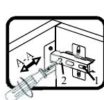
Если створка наклонена вправо или влево относительно вертикали корпуса, нужно выпрямить наклон створки в направлении А-А винтом 2.
