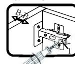
Если нижняя или верхняя часть створки отстает от корпуса, нужно ослабить винт 1 и сдвинуть створку в направлении В-В, а затем затянуть винт 3.
